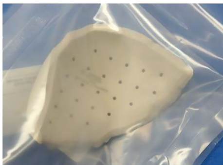
Рис. 5. Черепной имплант, изготовленный из полиэфиркетона (PEEK) методом прямой 3D-печати с использованием FDM-технологии
